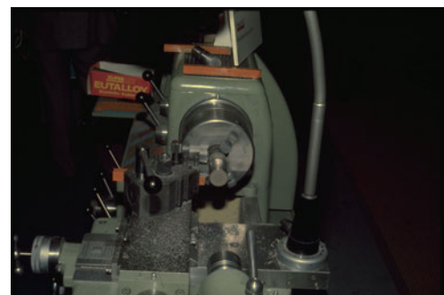
Abbildung 2: drebolid-B beim Überdrehen eines metallpulverbeschichteten Stahlteiles
