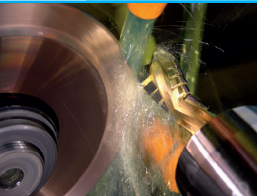
Graphit – Rücken und Fase in einem Schritt
