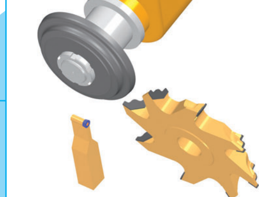
Profilwerkzeug mit Graphit- scheibe – Einstechverfahren
