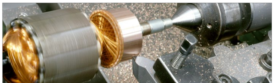
Überdrehen eines Kupfer-Kollektors mit einer der ersten hergestellten dreborid-Dreh-Diamanten.
