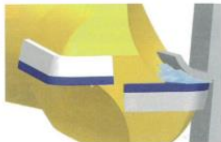
Das Kühlsystem kühlt den heißen Span gezielt nach der Entstehung durch die geöffnete Spanfläche der PKD-Schneide (© Lach Diamant)
