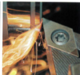
Schneidplatte »CBN-DUO-power« für das Fertig-Drehen hochlegierter gehärteter Stähle und von Grau-Guss im Einsatz (Bilder: Lach Diamant Jakob Lach GmbH & Co. KG, Hanau)
