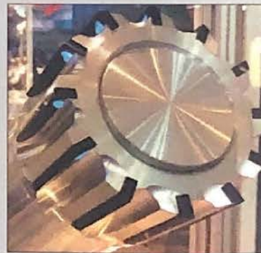
»Cool Injection« – Kühlung direkt durch die PKD-Schneide und auf den Punkt gebracht (Demo).
