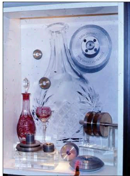
Im Boom der 60er Jahre: Metallgebundene Diamant-Schleifscheiben für das automatisierte Schleifen von Kristall-Gläsern auf Kutscher-Automaten.
