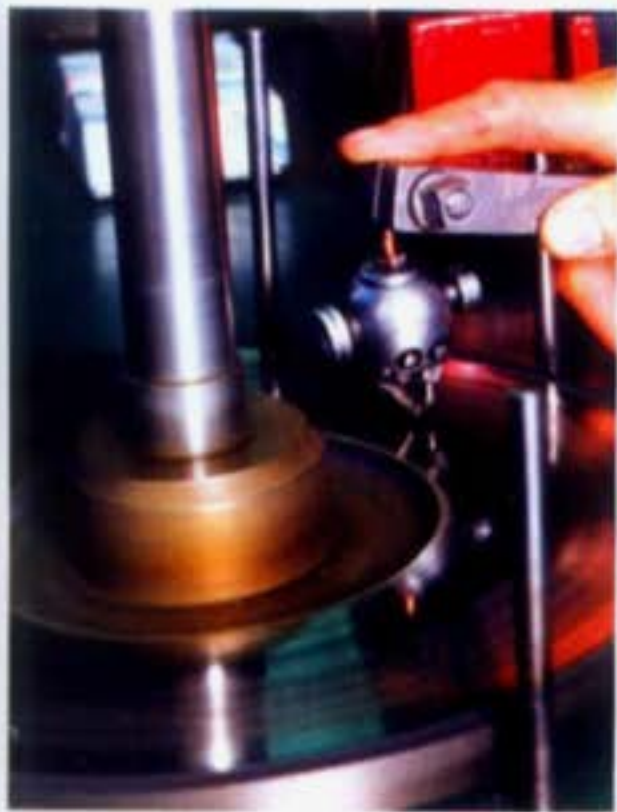
Bild 1: Schleifen von Industrie-Diamanten als Beispiel für den Service an Einzel-Abricht- und Profil-Diamanten (Werkbilder: Lach Diamant Jakob Lach GmbH & Co. KG, Hanau)
