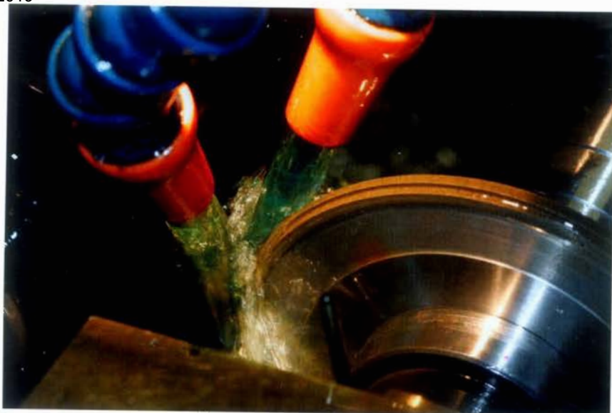
Bild 1: EDG-plus®-Funkenschleifmaschine »mini-contour-profiled« beim Profilieren einer metallgebundenen CBN-Schleif- scheibe
