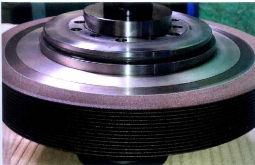
Bild 3a + b: Beispiel der fast grenzenlosen Möglichkeiten der Symbiose des von Lach Diamant entwickelten Verfahrens zur Herstellung metallgebundener Profil-Schleifscheiben. Im Bild Prüfschablone der »contour-profiled« CBN-Schleifscheibe für einen Haartrimmer – Profiltiefe 13,5 mm bei einer Stegbreite von 0,5 mm. Einsatz erfolgt im Tiefschliff (Werkbilder: Lach Diamant Jakob Lach GmbH & Co. KG, Hanau)
