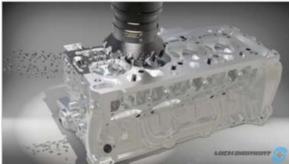
Lach Diamant Monoblock-Fräser »dia-compact« sofort einsatzfertig durch Plug + Play (Bild: Lach Diamant)
