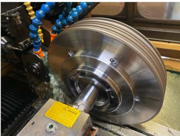
Revolutionäres Tiefschleifen mit »contour-profiled« metallbegundenen Diamant- bzw. CBN-Profil-Schleifscheiben – im Bild Profilieren einer CBN-Schleifscheibe \varnothing 400 mm auf der mini »contour-profiled«-Funktenschleifmaschine EDG-plus.
