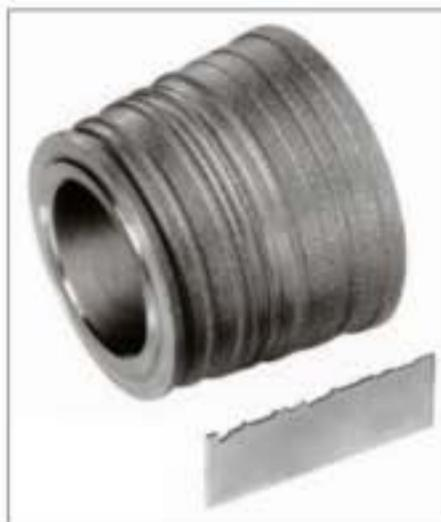
Das Bild zeigt die Abrichtrolle „rotary dress“ mit dazugehöriger Profilschablone von Lach Diamant. (Bild: Lach Diamant)
