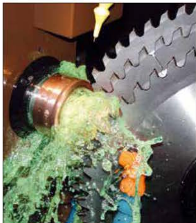
Beispiel: Schleifen von Dia-Sägeblättern mit dem Programm Mehrfach-Fertigung.
