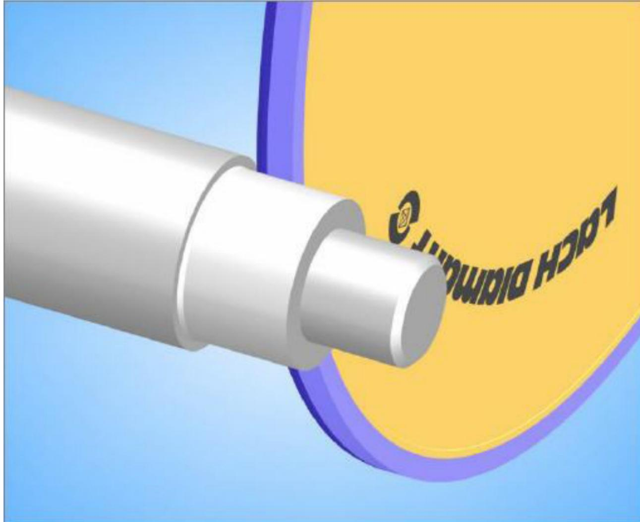
Die neu entwickelten LACH Diamant- und CBN-Schleifscheiben werden mit zwei Schleifbelägen hergestellt und ermöglichen dadurch das vollständige Schältschleifen - und zwar Schruppen und Schlichten - in einem einzigen Arbeitsgang.
