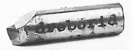
Bild 3: Synthesediamant für das Innerdrehen der Schneidenform BA
