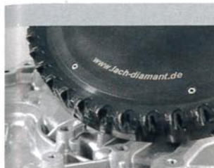
Servicefreundlicher CFM-Planfräser – PKD-bestückt bis Durchmesser 400 mm für HSC-Zerspanung.
