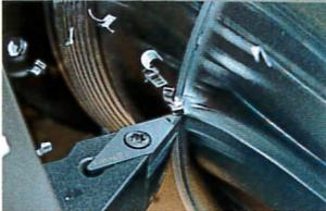
PKD-Schneidplatte mit aktivem Spanbrecher IC-plus beim Drehen von Aluminium bei Zustellung (ap) 2,0 mm.
