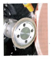
Zerspanung – js. Mit einer Arbeitsbreite von 0,6 bis 1,5 mm ist die als "Scheibe" ausgebildete Diamant-Abrichtrolle Drebojet-plus
