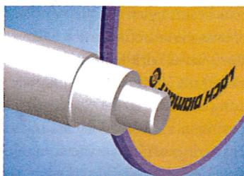
Laut Hersteller erfüllen sie die gestellten Anforderungen bezüglich Genauigkeit und Oberflächen-güte. Dabei wird die Bearbeitungszeit bis 50 % reduziert. Die metallischen oder keramischen Bindungen gewährleisten einen sicheren, konstanten Schleifprozess gepaart mit einer hohen Standzeit. Abhängig von den Schleifbedingungen und den Anforderungen werden sie mit verschiedenen Grundkörpern hergestellt.
