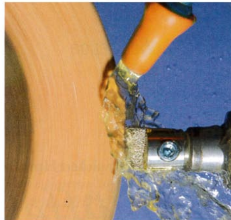
Die Dia-Fliese-perfect belegt mit Diamant-Körnung beim Abrichten einer Schleifscheibe
