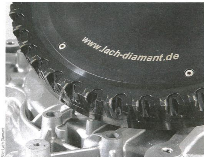
PKD-bestückter Planfräser für die HSC-Zerspangung.
