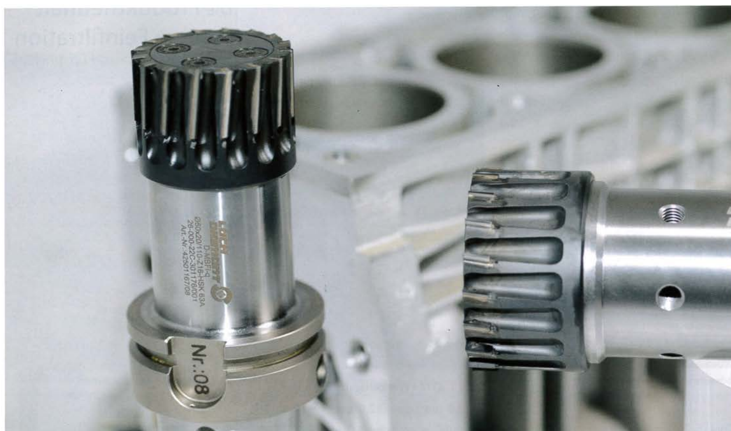
PKD-Monoblock-Fräser »Cool Injection-Plus« mit Kühlung direkt durch die Spanfläche und Spanabweiser
