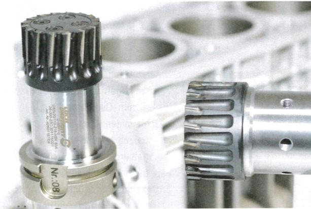
**Gute Zusammenarbeit:** Der PKD-Fräser ›Cool Injection-Plus‹ kombiniert die Lach-Diamant-Kühlung mit dem Spanabweiser von Audi.
