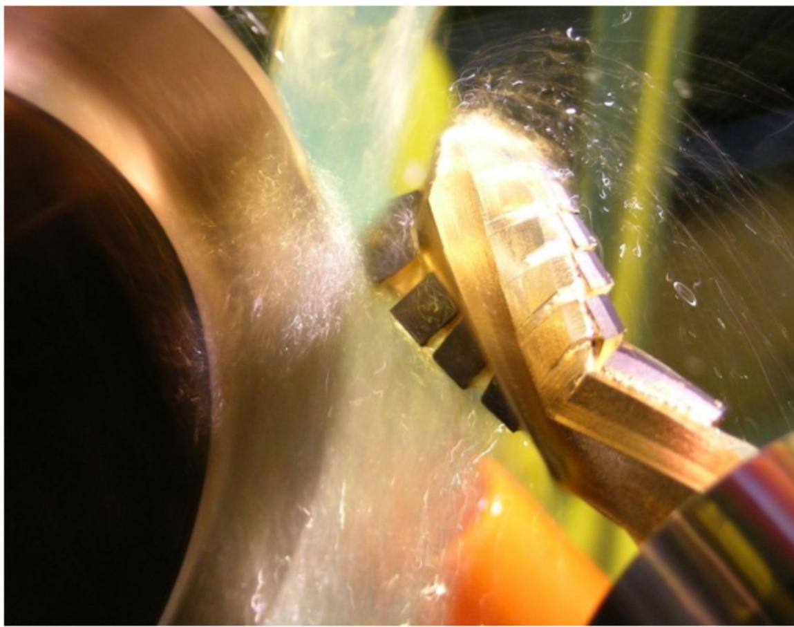
PKD-Schaftfräser mit extremen Achswinkeln für die Holz- und Composite-Bearbeitung – präzise geschärft auf der "Dia-2200-mini". - Bild: Lach Diamant
