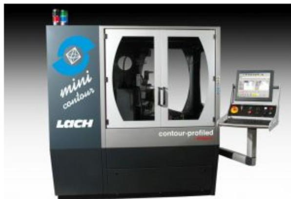
Sondermodell "Dia-contour-profiled" für das präzise Profilieren metallgebundener Diamant- und CBN-Schleifscheiben. - Bild: Lach Diamant
