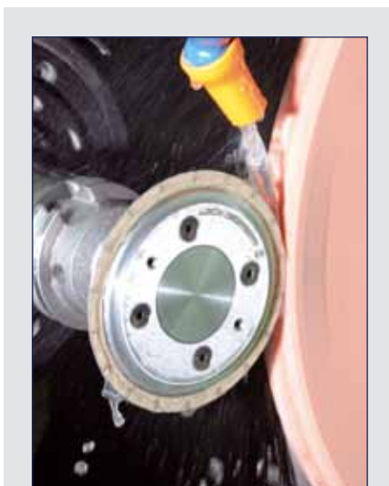
2016 – GrindTec, Augsburg: Die Vorstellung von drebojet®-plus als Symbol für nicht nachlassende Innovation. Das bahngesteuerte Abrichten konventioneller Schleifscheiben auf dem LACH DIAMANT-Stand.
