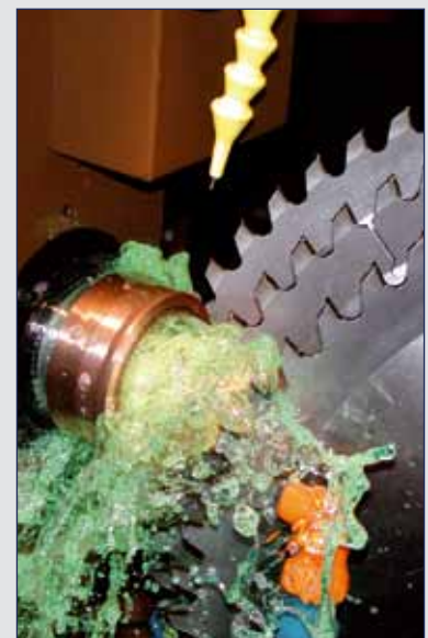
1978 – die Entdeckung der Funken-erosion durch Horst Lach machte es möglich – Beispiel: Mehrfachfertigung von DiaSägen auf der LACH DIAMANT-Universal-Schärfmaschine »Dia-2200-mini«.
