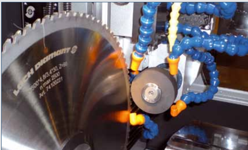
PKD-Säge ø 500 mm mit 90 Zähnen (Z=90) wird auf einer LACH-Funkenschleifmaschine hergestellt.
