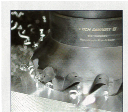
2004 wurde LACH DIAMANT für die Entwicklung des Monoblock-PKD-Fräsers mit dem Hessischen Innovationspreis ausgezeichnet. Bereits hier zu erkennen: die Span- und Achswinkel, die mit dem großen Spanraum zu einer deutlichen Reduzierung der Bearbeitungskräfte führen.
