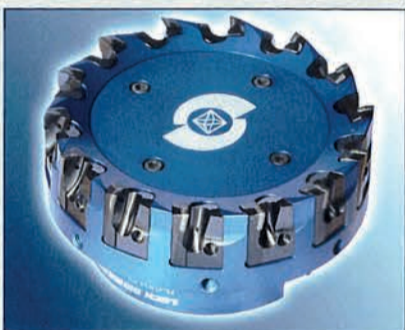
LACH DIAMANT-PKD-Kassettenfräser »dia-blue-power« – mit formschlüssigen Druckstücken und radiusförmigem Spanraum, die max. Zustellung bis 6 mm erlauben – bei größter Sauberkeit am Bauteil.
