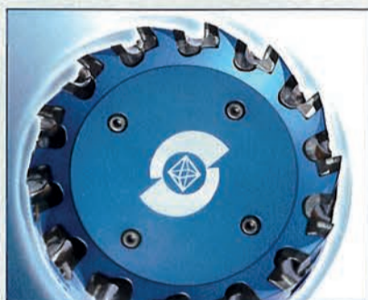
LACH DIAMANT-PKD-Kassettenfräser »dia-blue-power« – mit formschlüssigen Druckstücken und radiusförmigem Spanraum, die max. Zustellung bis 6 mm erlauben – bei größter Sauberkeit am Bauteil.
