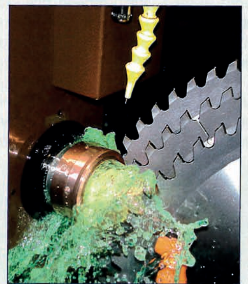
1978 – die Entdeckung der Funkenerosion durch Horst Lach machte es möglich – Beispiel: Mehrfachfertigung von DiaSägen auf der LACH DIAMANT-Universal-Schärfmaschine »Dia-2200-mini«.
