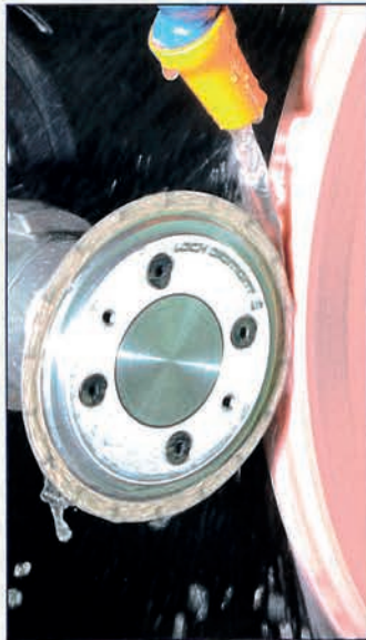
2016 – GrindTec, Augsburg: Die Vorstellung von drebojet®-plus als Symbol für nicht nach- lassende Innovation. Das bahngesteuerte Abrichten konventioneller Schleif- scheiben auf dem LACH DIAMANT-Stand.
