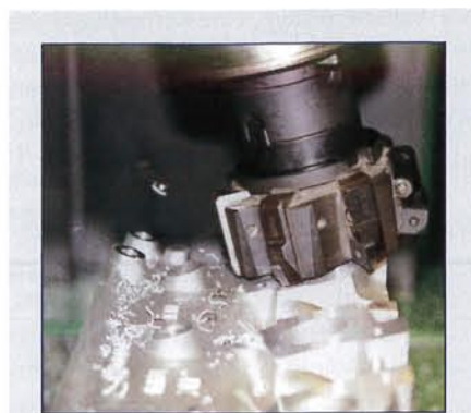
Erstmals Fräsen von Aluminium mit PKD-Fräsern.
