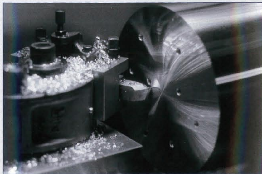
PKD-Drehwerkzeuge dreborid® erstmals vorgestellt für hartmetall-überlegenes Drehen von Aluminium.
