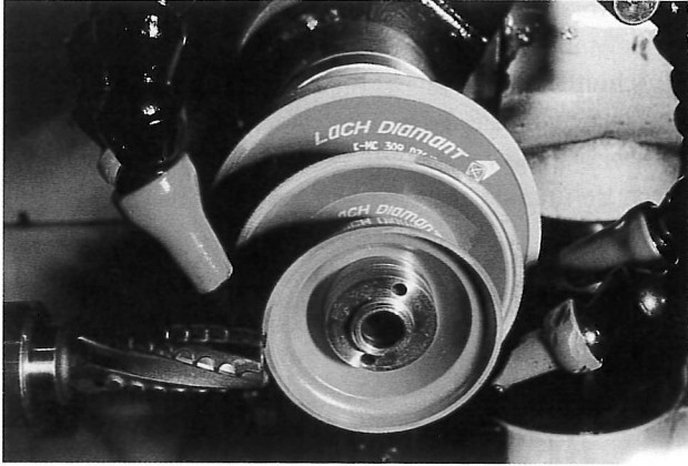
CNC-Werkzeugschleifen mit LACH-Diamant- und CBN-Schleifscheiben
