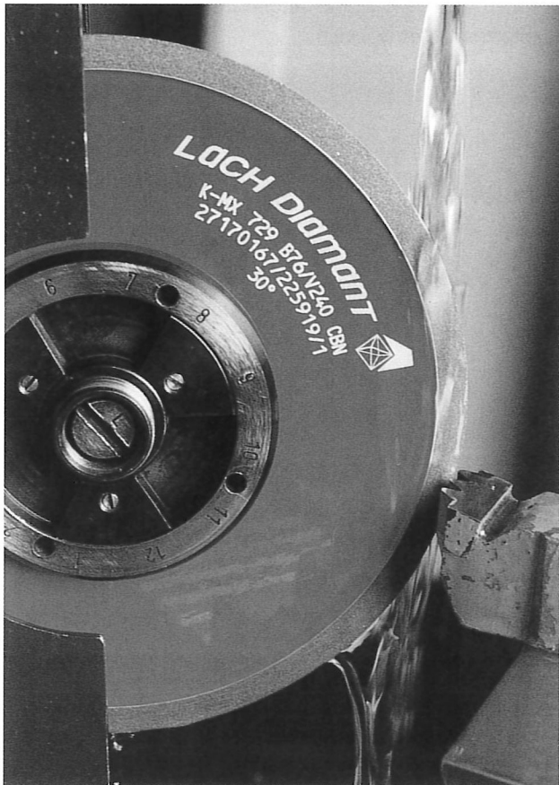
Profil-Scheiben mit LACH-DIAMANT am Beispiel der PeTeWe-Profilschleifmaschine Werkfotos: LACH-DIAMANT
