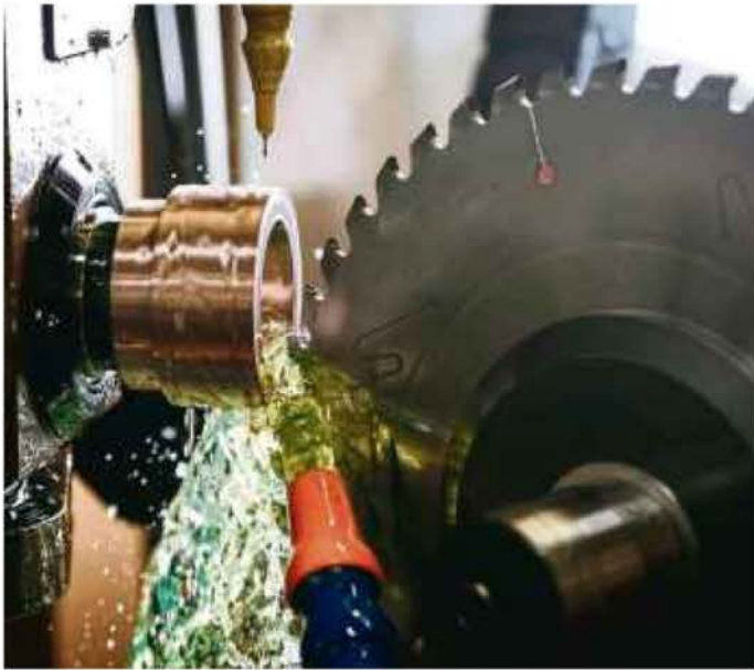
Das Schärfen von Werkzeugen mit Funkenerosion ist eine der vielen Anwendungserfindungen im Hause Lach. FOTOS: MIKE BENDER (3)
