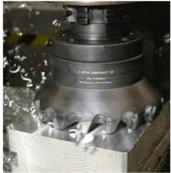
Mit speziell konstruierten Diamantfräsern werden beispielsweise die Oberflächen von Motorblöcken aus Aluminium bearbeitet. FOTO: LACH DIAMANT
