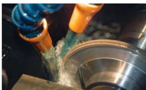
EDG-plus-Funkenschleifmaschine mini-contour-profiled beim Profilieren einer metallgebundenen CBN-Schleifscheibe.
