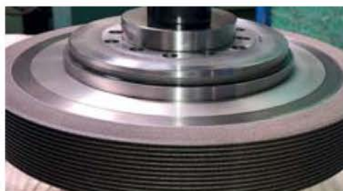
Prüfschablone der contour-profiled CBN-Schleifscheibe für einen Haartrimmer – Profiltiefe 13,5 mm bei einer Stegbreite von 0,5 mm. Einsatz erfolgt im Tiefschliff.
