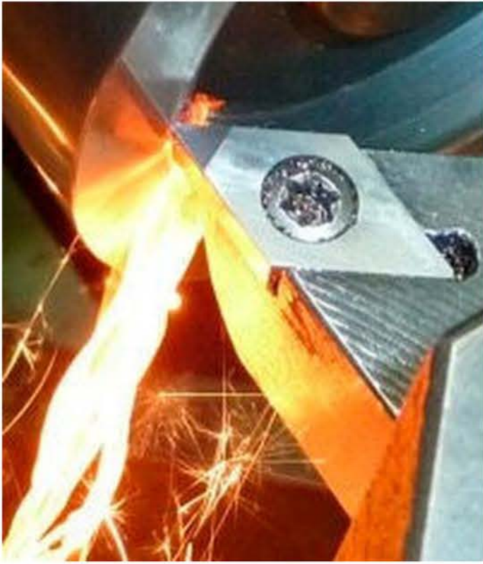
Drehen statt Schleifen – und zwar gehärtete Stähle – ist das Motto, das Lach Diamant bezüglich der neuen CBN-Wendeschnidplatten namens CBN-Duo-Power ausruft. (Bild: Lach Diamant)
