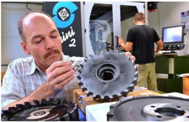
**Lach Diamant bietet jetzt Nachschleifservice für PKD-Werkzeuge an – auch für Fremdfabrikate, und was die Reparatur respektive Neubestückung von Einzelstücken und Sägen angeht.**
