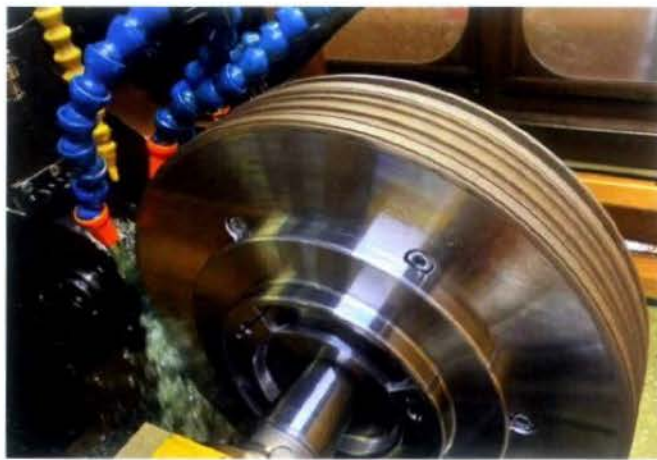
Bild 2: Tiefschleifen in neuer Dimension mit »contour-profiled« metallgebundenen Diamant- bzw. CBN-Profil-Schleifscheiben – im Bild Profilieren einer CBN-Schleifscheibe ø 400 mm auf der mini »contour-profiled«-Funktenschleifmaschine EDG-plus
