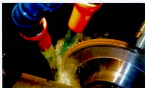
EDG-plus-Funkenschleifmaschine mini-contour-profiled beim Profilieren einer metallgebundenen CBN-Schleifscheibe.
