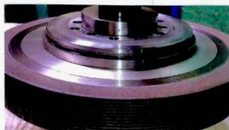
Prüfschablone der contour-profiled CBN-Schleifscheibe für einen Haartrimmer – Profiltiefe 13,5 mm bei einer Stegbreite von 0,5 mm. Einsatz erfolgt im Tiefschliff.
