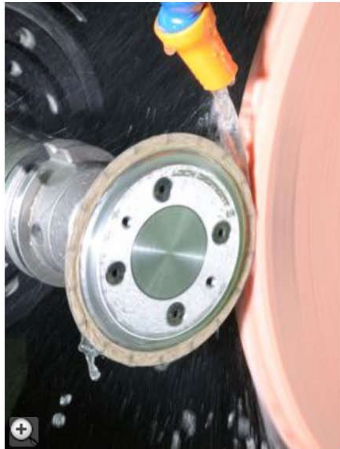
Die Präzisions-Abrichtrolle ›drebojet-plus‹ beim Profilieren einer konventionellen Schleifscheibe (Bild: Lach Diamant)
