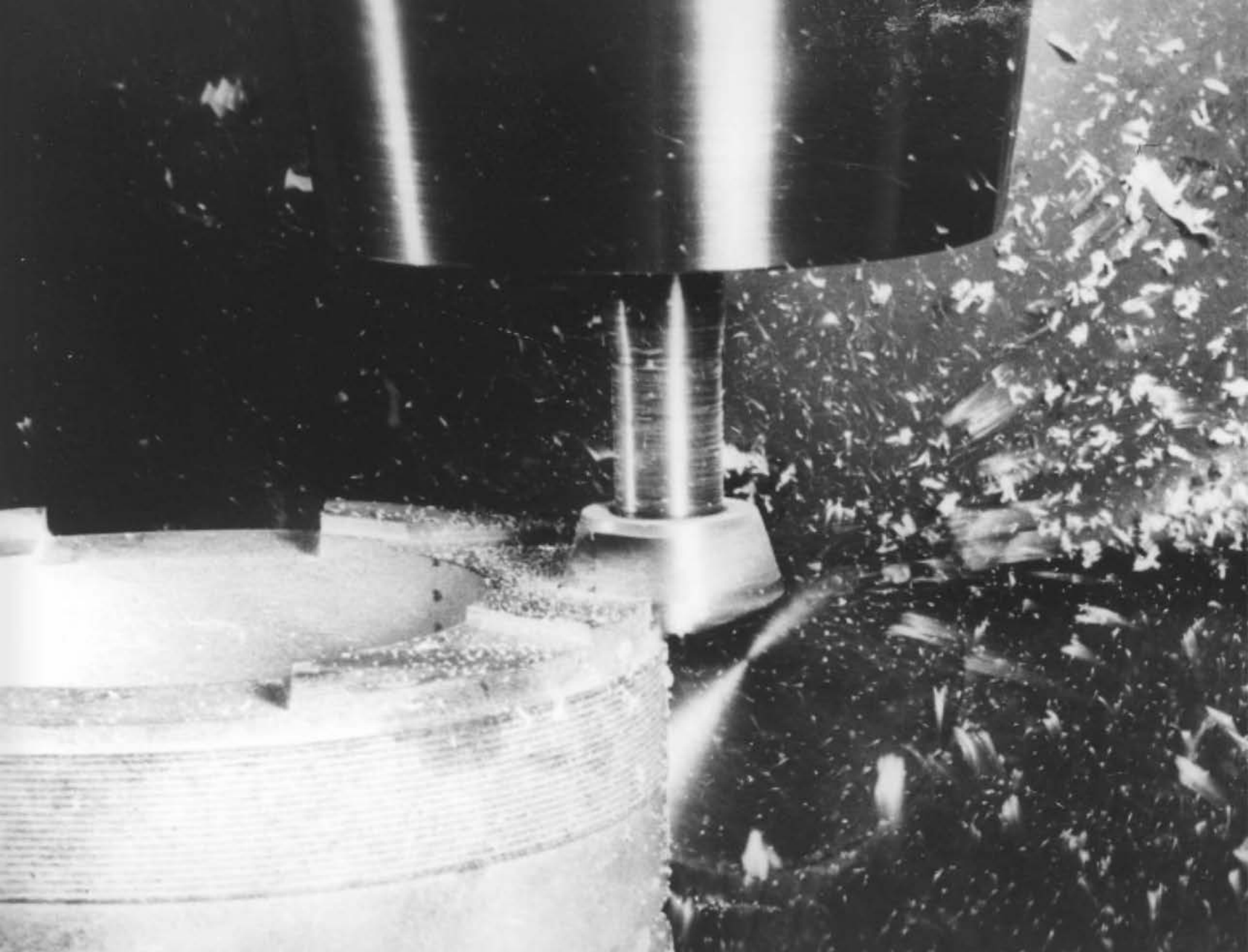
Usinage PCD de plastique renforcé de fibres de verre pour l'essai de 1974.
