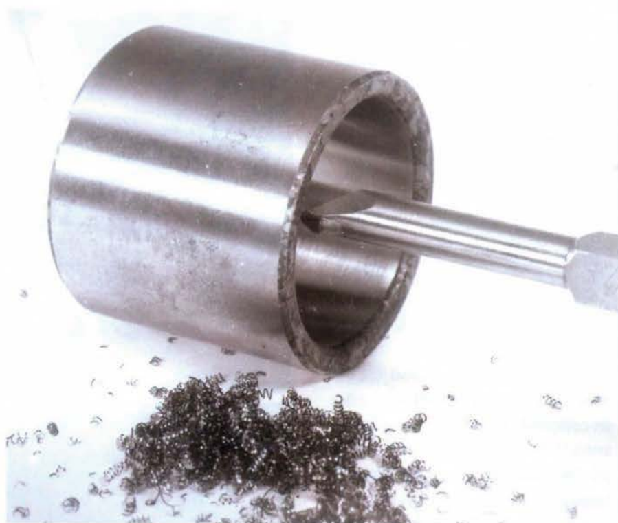
Tournage intérieur avec outil de coupe PCD, au stade de développement, en 1973-1974.
