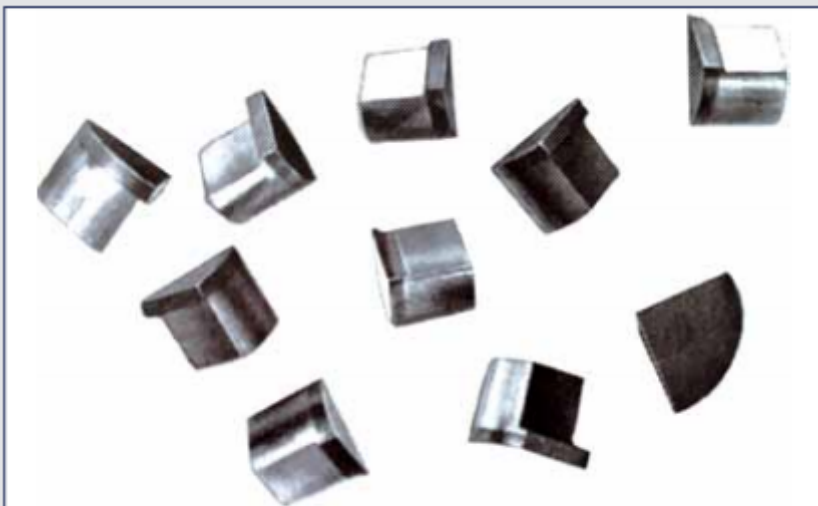
Crude composite cutting inserts. Source: "Bericht Schnelleres Drehen, Bohren und Fräsen..." Horst Lach MM Issue 11/1973.
