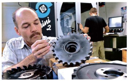
Die Diamanten verhelfen Werkzeugen für Dreh-, Fräs- und Bohroperationen mit zu hoher Widerstandsfähigkeit, so dass zukünftig unter Einsatz von "Cool Injection"-Kühlung direkt sogar Titan und Stahl bearbeitet werden kann. Alle Werkzeuge werden nach ISO mit CNCgesteuerten Messmaschinen geprüft.
