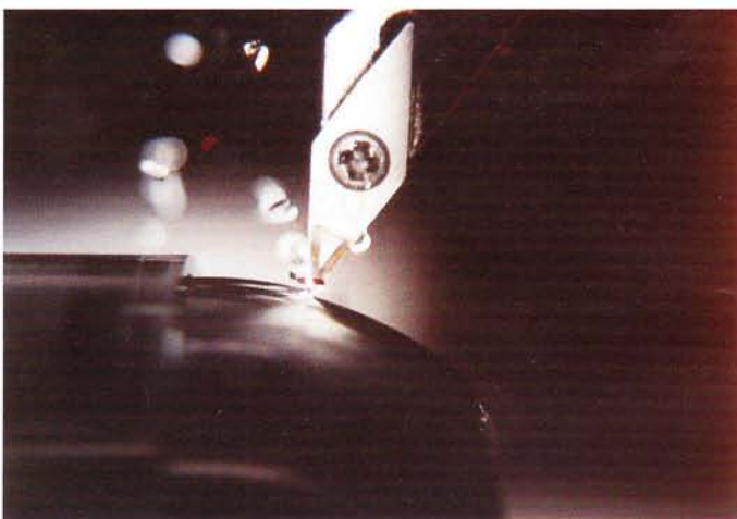
Bild 2: Kontrollierter Spanbruch (Werkbilder: Jakob Lach Diamant- und Bornitrid-Werkzeug- fabrik, Hanau/M)
