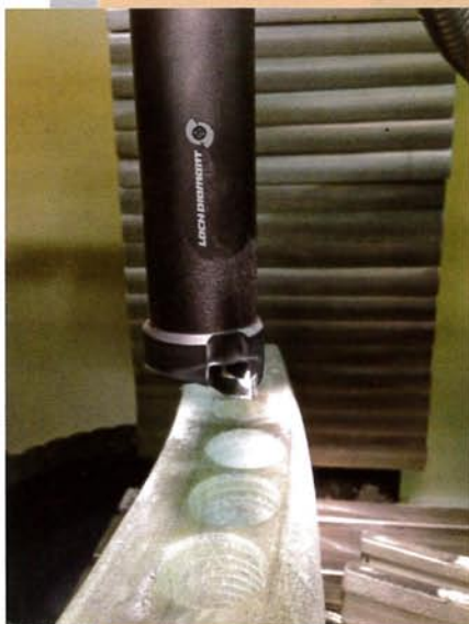
LACH DIAMANT-PKD-Vollbohrer mit Innenabsaugung beim Bohren von glasfaserverstärktem Material (GFK).
