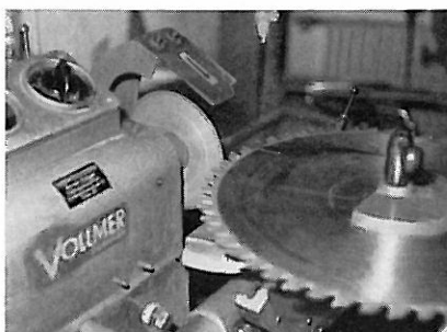
4 Brustschleifen eines Hartmetallsägeblattes auf einer Vollmer-Dornhan-Unilapp mit Scheibenform 146-C
