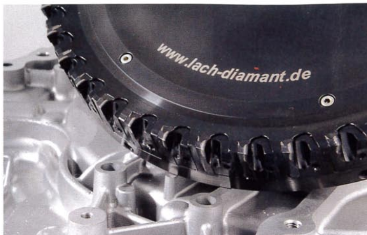
CFM-Planfräser – PKD-bestückt bis \varnothing 400 mm für HSC-Zerspanung. Bild: Lach Diamant
