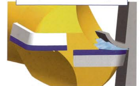
2010/12: Cool Injection wirkt direkt, verlustfrei aus der PKD-Spanfläche auf den Span, kühlt, schmiert, transportiert und bricht den Span.
